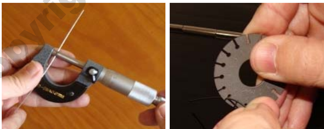
Midiendo el calibre de una cuerda, con micrómetro y con guía
