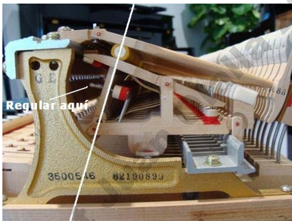
Punto exacto de regulación de la palanca de escape
